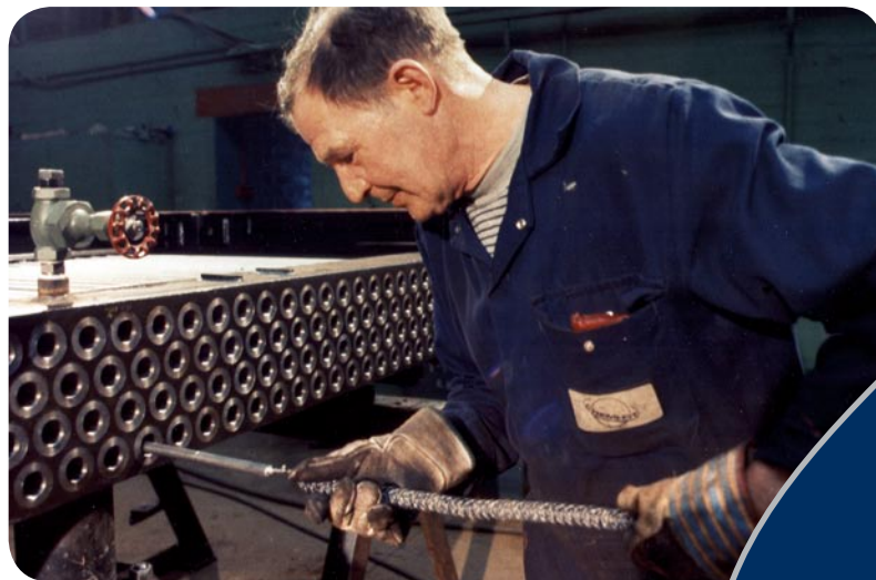
↑:Shell 石油、ナイジェリア向けの空気式冷却器 hiTRAN マトリックス・エレメントを 3時間以内に装着
