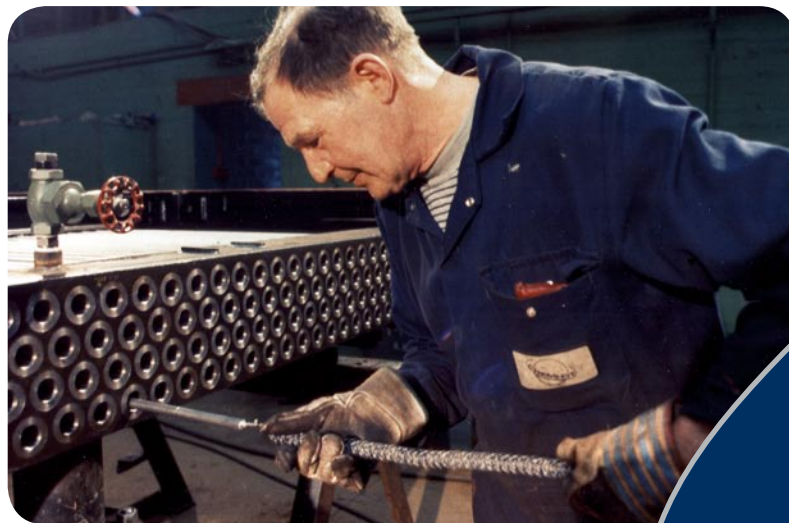
Сверху: Воздушный охладитель для Shell Oil, Нигерия, оборудованный интенсификаторами hiTRAN менее чем за 3 часа.
